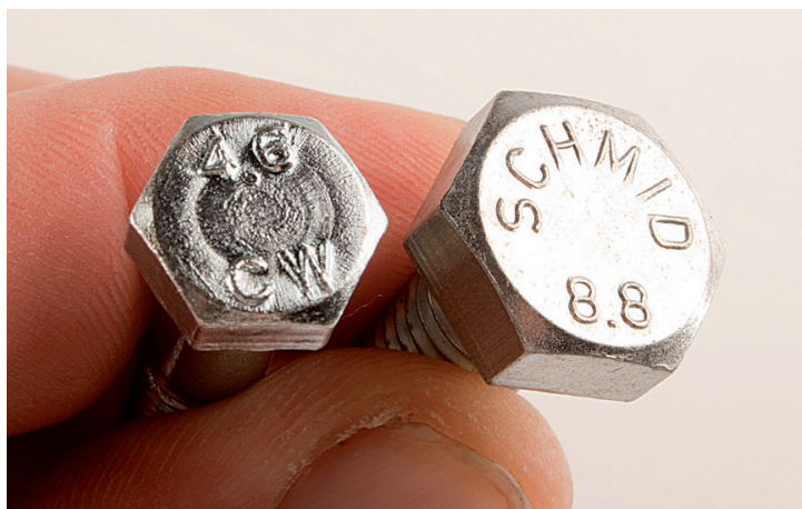
Reißfestigkeit und Streckgrenzen: Die 4.6er Schraube reißt bereits bei der Hälfte der Belastung und ist nichts für sicherheitsrelevante Teile
