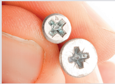
Phillips gegen Pozi: Im Zweifel zum PH-Schraubendreher greifen
