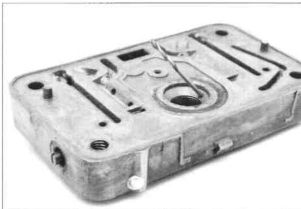
Die Kanalverengungsbohrungen zum Lastanreicherungsventil werden mit dem Schaft eines Bohrers geprüft, um sicher zu stellen, dass die Bohrungsgröße in diesem Platineblock korrekt ist.
