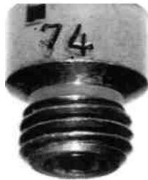
Die Nummer für die Düsengröße einer Holley-Düse ist an der Seite der Hauptdüse aufgeprägt. Bei diesem Exemplar handelt es sich um die Größe 74, deren Bohrung einen Durchmesser von ca. 0,081 Zoll aufweist.
