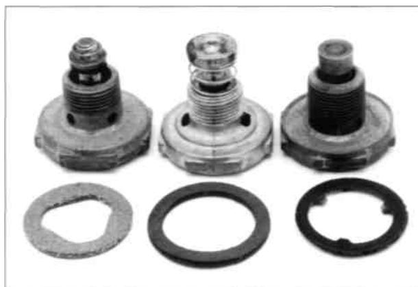
Lastanreicherungsventile späteren Baudatums mit vier Bohrungen und glatter Dichtungsfläche werden mit einer Unterlegscheibe mit dreieckiger Aussparung, wie links dargestellt, montiert. Die aktuell verwendeten Lastanreicherungsventile mit Aussparungen erhalten eine große, einfache Unterlegscheibe, siehe Mitte. Lastanreicherungsventile mit vier Bohrungen früheren Baudatums sind mit einer Kante am äußeren Umfang versehen und die Unterlegscheibe hat drei Laschen - siehe rechts.
