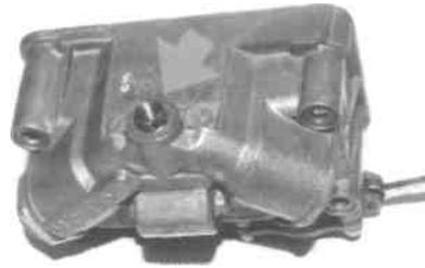
Bauteile zum Einstellen des mittig angelegten Schwimmers in der Schwimmerkammer, siehe rechts. Schwimmernadelventil und Sitz sind in der Schwimmerkammer angeordnet. Rechts dargestellte Faserscheibe mit großem Durchmesser wird zuerst über das Messinggewinde von Schwimmernadelventil und Sitz gelegt, gefolgt von der Sechskantmutter und der Faserscheibe mit kleinem Durchmesser. Diese Bauteile werden von der links dargestellten Befestigungsschraube in Einbaulage gehalten.
