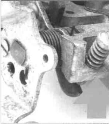
Leerlaufdrehzahl-Einstellschraube (siehe Pfeil) an einem Doppelvergaser
