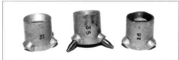
Gerade Bauart der Auslassdüse ist links und rechts dargestellt, in der Mitte die rohrförmige Bauart. Letztere ist mit Auslassbohrungen Durchmesser 0,035 Zoll versehen, was an der Nummer 35, die an der Seite aufgeprägt ist, erkennbar wird. So beträgt der Durchmesser der Auslassbohrungen der Düse in gerader Bauart links 0,031 Zoll, jener der rechten Auslassdüse 0,028 Zoll.
