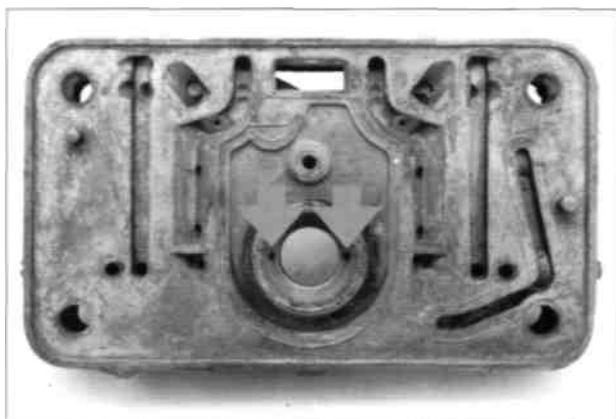
Die beiden mit Pfeil markierten Kanalverengungsbohrungen des Lastanreicherungsventils sind vom Hersteller Holley speziell dimensioniert, um die Kraftstoffmenge, die in die Hauptdüsenaufnahmen strömt, genau zu regeln.
