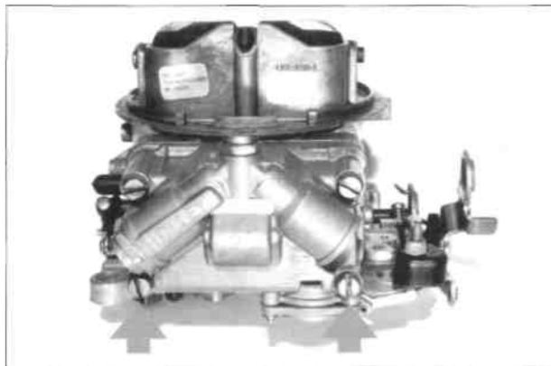
Immer sicher stellen, dass sich die Faserscheiben an den unteren beiden Befestigungsschrauben der Schwimmerkammer in einwandfreiem Zustand befinden - siehe Pfeile. Ersatzscheiben für den Fall zur Hand haben, dass diese undicht werden.
