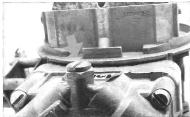
Einstellmechanismus für Schwimmerkammerniveau im eingebauten Zustand, siehe Pfeil.
