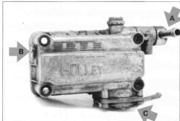
Die Schwimmerkammer mit seitlich angelenktem Schwimmer der Primärstufe ist an der rechten Seite mit Kraftstoffeinlass bei Pfeil A versehen. Der Prüfstopfen für Kraftstoffstand befindet sich bei Pfeil B an der linken Seite und die Beschleunigerpumpe an der Unterseite rechts bei Pfeil C. Auch die Formgebung dieser Schwimmerkammerbauart lässt eine einfache Unterscheidung zu.
