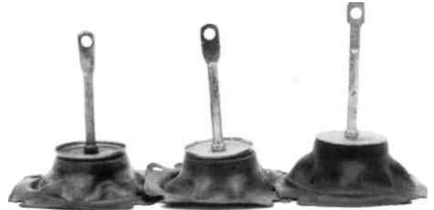
Die drei Membran- und Gestängebaugruppen für Unterdruckbetätigung der Sekundärstufe an Vierfachvergäsern von Holley.
