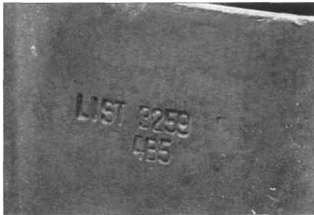
Die Listennummern sind an den Starterklappengehäusen der Vergasergehäuse aller dieser Holley-Vergaser an der dargestellten Stelle eingepreßt. Dieser Code LIST 3259 bedeutet, dass es sich hier um einen Vierfachvergaser mit unterdruckbetätigter Sekundärstufe und 725 cfm Luftdurchsatz handelt.
