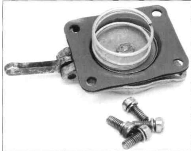
Gehäusemembran-Rückstellfeder und vier Befestigungsschrauben für Beschleunigerpumpe mit 30 ccm Einspritzmenge.
