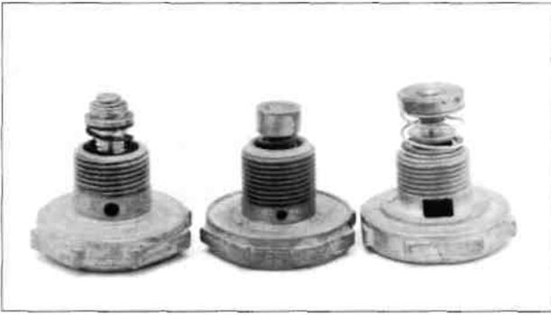
Die drei am häufigsten anzutreffenden Bauarten von Lastanreicherungsventilen. Lastanreicherungsventil mit vier Bohrungen jüngerer Bauart ist links dargestellt, jenes mit vier Bohrungen älterer Bauart in der Mitte und das aktuell hergestellte Lastanreicherungsventil mit Aussparung rechts.
