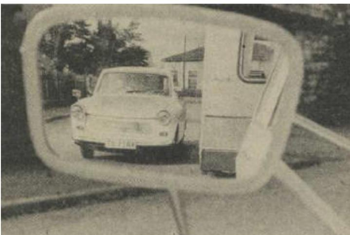
Abb. 35 Überholende Fahrzeuge und eigener Anhänger sind bei genügend langen Spiegelhalterungen gut zu sehen
