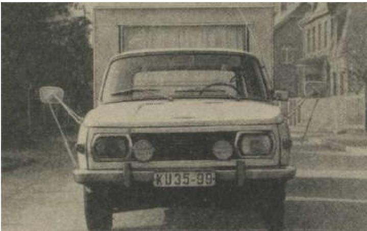
Abb. 34 Spiegelhalterungen dieser Art ermöglichen trotz des breiten Anhängers eine gute Sicht nach hinten
