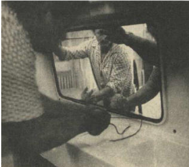
Bild 4.92. Indem die Schnur der Dichtungslippe herausgezogen wird, legt sich die Dichtungslippe über den Falz an die Innenhaut an
