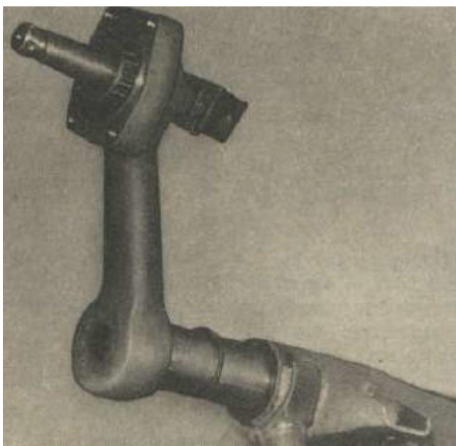
Bild 4.4. Schwingarm im teilweise herausgeschlagenen Zustand
