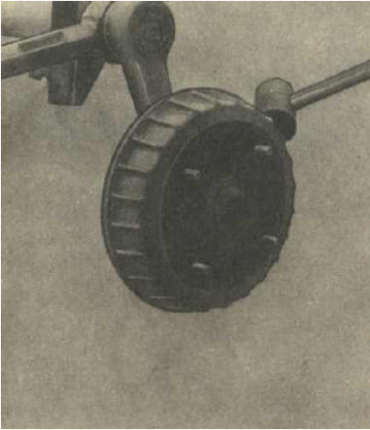
Bild 4.21. Bei festsitzender Bremstrommel genügt oftmals ein Schlag mit dem Gummihammer gegen den äußeren Scheibenrand der Bremstrommel
