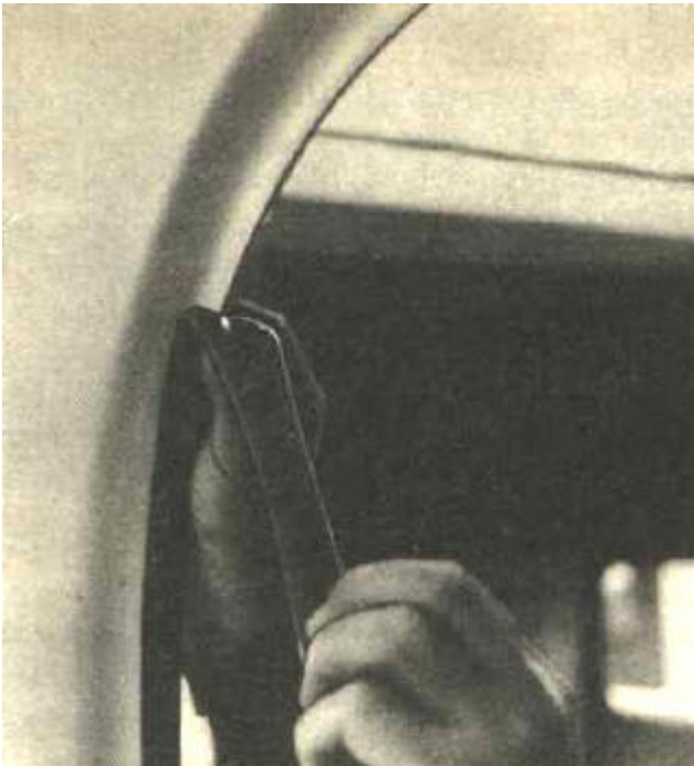
Bild 4.85. Aufstecken des Gummiprofiles auf den Flansch des Türausschnittes beim QEK Junior
