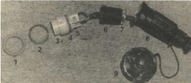
Bild 4.131. Einzelteile der Anschlusssteckdose K 10-250-3 1 Dichtgummi; 2 Nutmutter; 3 Porzellangehäuse; 4 Dichtring; 5 Anschlussklemmen; 6 Schutzhülle; 7 Kabelschelle; 8 Gehäuse; 9 Bajonettverschluss
