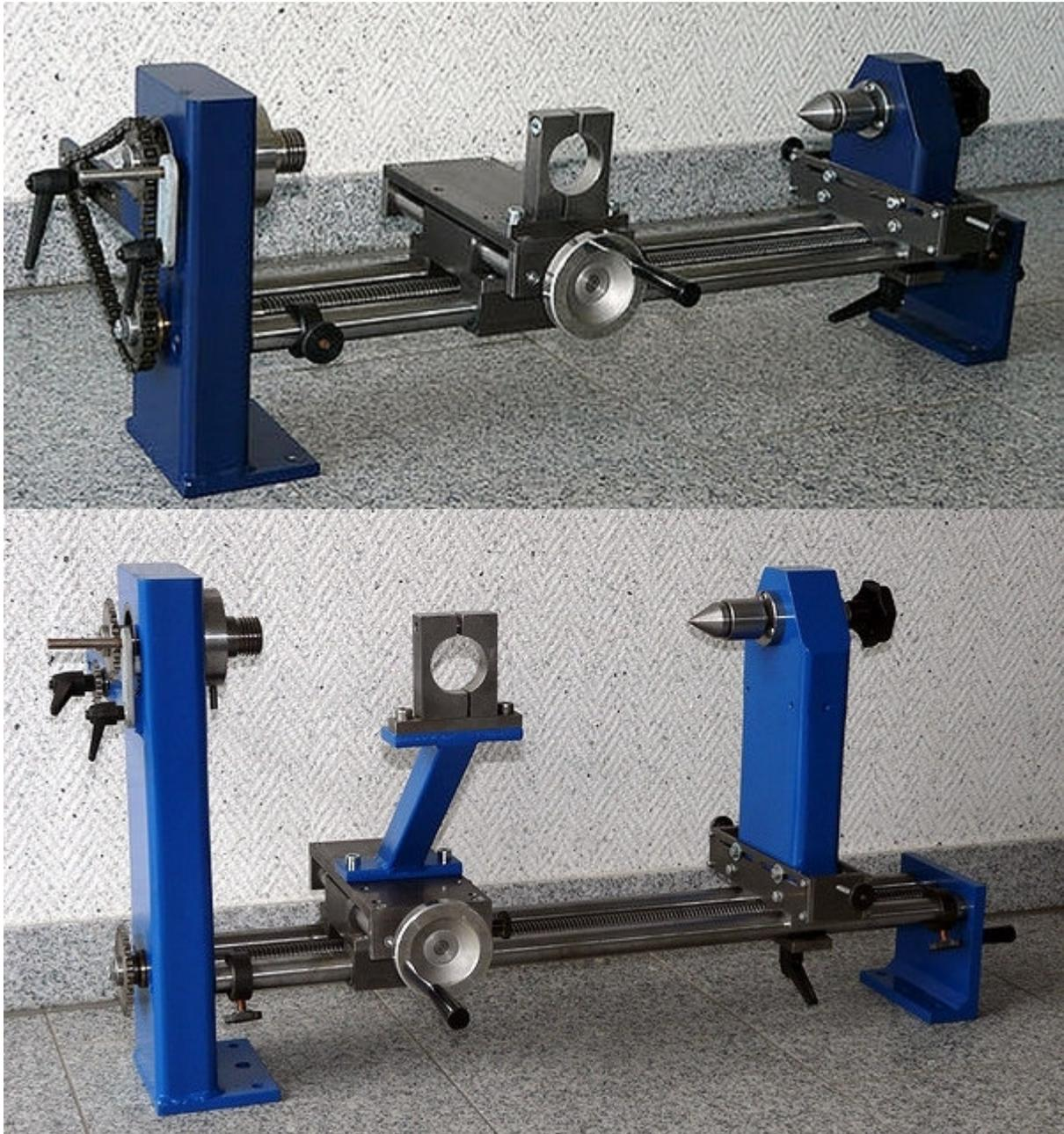
Das Gerät dient dazu, Windungen oder Gewinde in Hölzer zu fräsen. Es ermöglicht auch sogenannte Kannelierungen, oder Rundfräsen.
